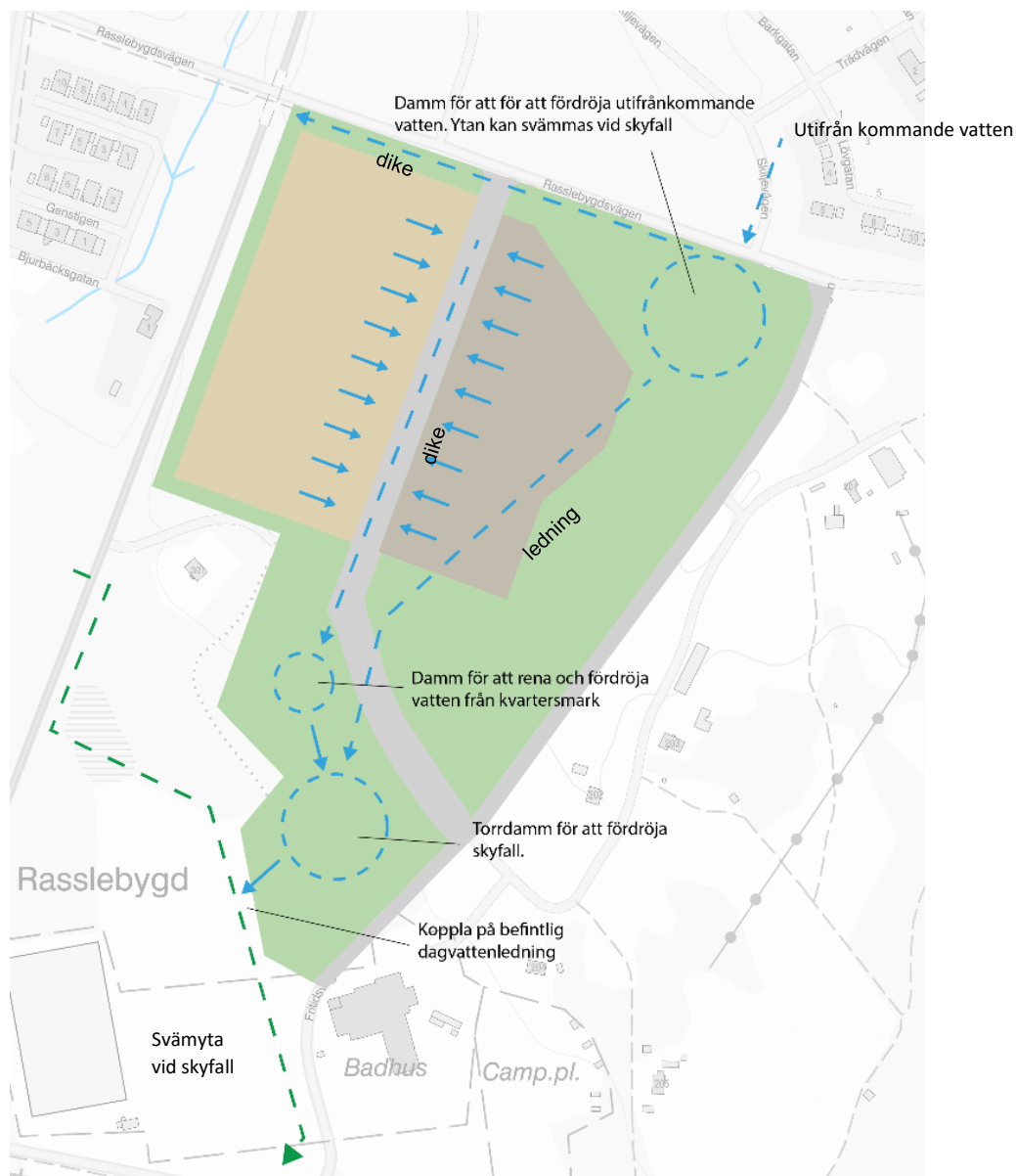
Figur 4. Illustration över föreslagen dagvatten- och skyfallshantering.
