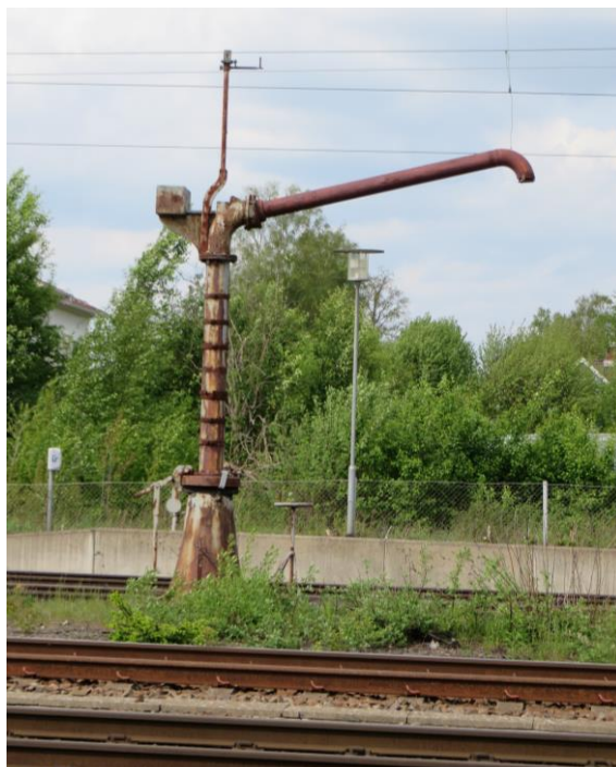
Mitt bland järnvägsspåren står en "vattenhäst" som användes för att fylla upp ångloken.
