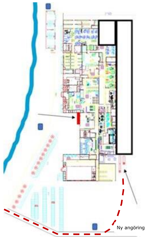
Figur 2. Utökning av fastigheten planeras mot öster och visas som ytor med svart linje. Pilar visar befintlig godsmottagning (röd markering) och ny placering av godsmottagning efter utbyggnad visas med pil i den sydöstra delen. Röd streckad linje visar planerad angöring till ny godsmottagning. Norr är riktad mot överkant på figuren.
