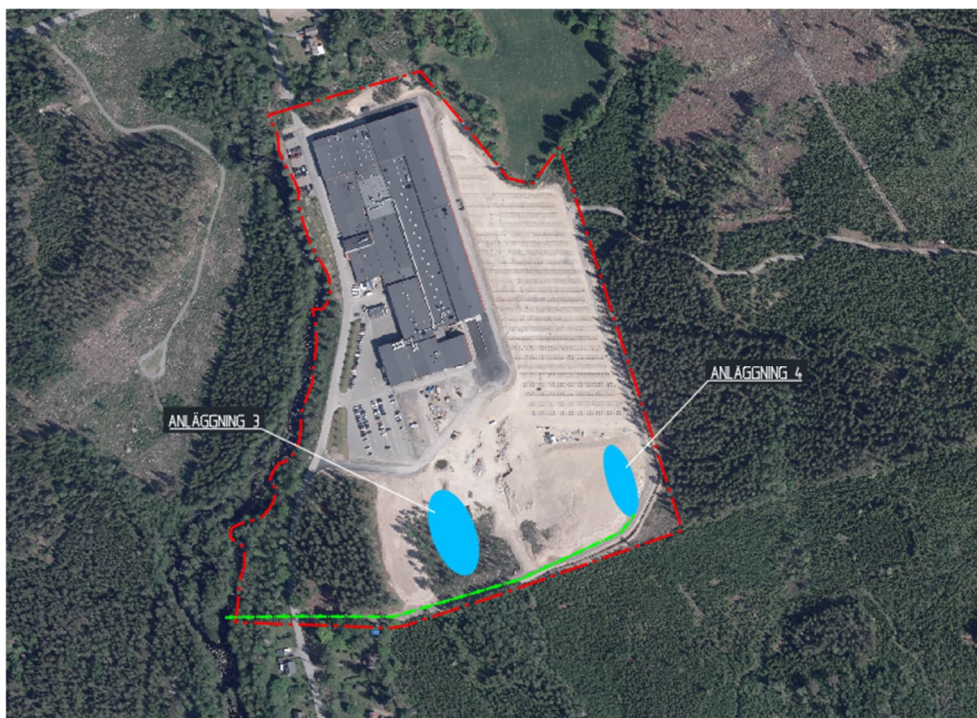
Figur 21. Schematisk skiss över dammarnas föreslagna ytor. Anläggning 3 är ca 2100 m 2 och anläggning 4 ca 1100 m 2
