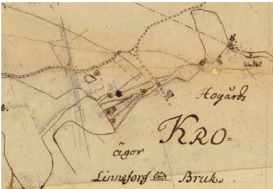
Denna karta (Skeppebo 1803) visar dammarna, de olika verksintagen och järnbrukets byggnader samt kvarnen nedströms. På kartan står "Wadet" för ett vadställe över ån. Vid bron syns smedbostaden som finns kvar än idag.
